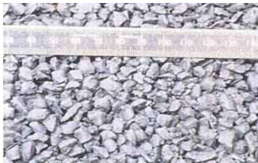
写真 - 19 常温タイプの荷重車走行後路面
