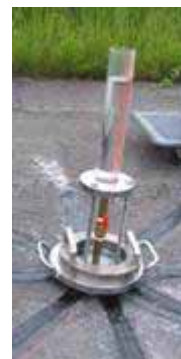
写真-9 透水量試験状況
