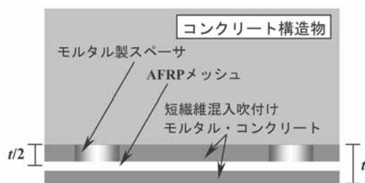
図 - 4.1 補修補強工法の概要
