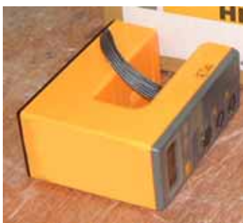
写真-3.2 高周波コンクリート水分計
