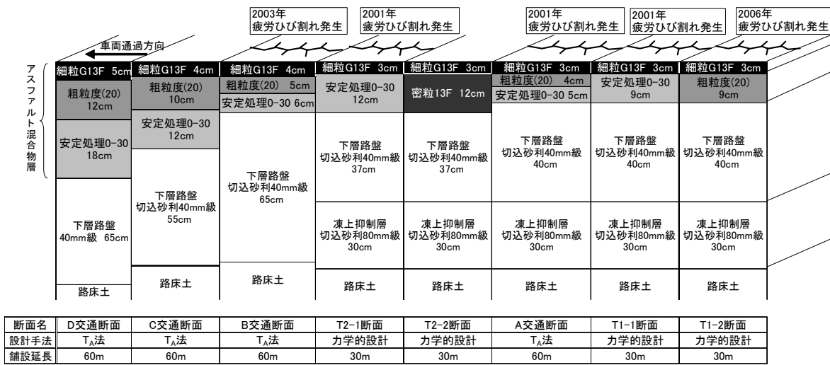
図 13 美々試験道路の疲労ひび割れ発生状況
