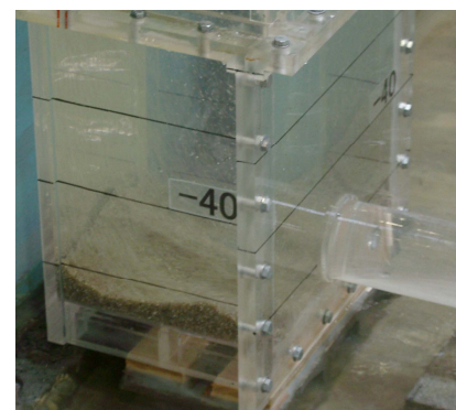
図-3.8 取水槽底面の土砂の堆積状況
