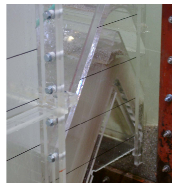
図-3.9 エア流入空間に土砂が入り込んだ様子
