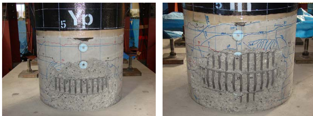
図-26 振動台加震実験による柱基部の曲げ損傷
