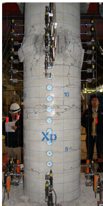
図-20 振動台加震実験による段落し部の曲げ損傷
