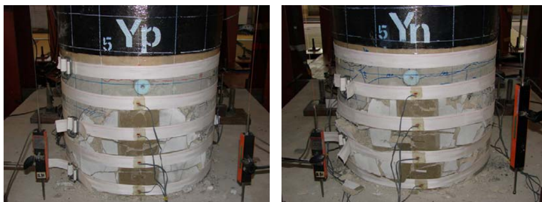
図-28 柱基部の修復後の再実験による修復部の損傷
