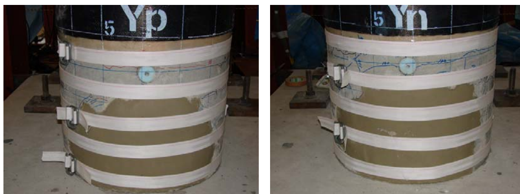
図-27 ポリエステル繊維バンドによる柱基部の修復
