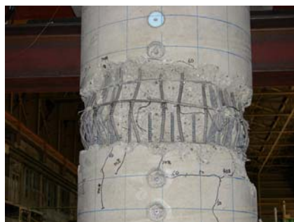
図-20 振動台加震実験による段落し部の曲げ損傷
