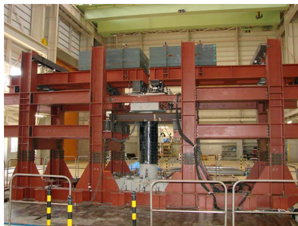
図-23 段落し部の曲げ耐力補強後
