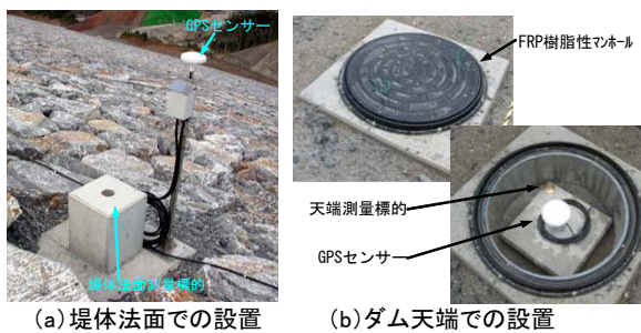
写真-4 フィルダム外部変形計測用 GPS センサ
