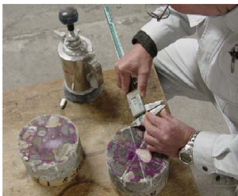
写真-2 中性化深さ測定状況
