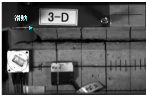
d) 実験 (滑動) 終了時 (28.05 秒) 写真-5 加振中の開口状況 (3-D①)
