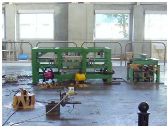
b) 落下防止フレーム及び水平荷重用おもり設置状況
