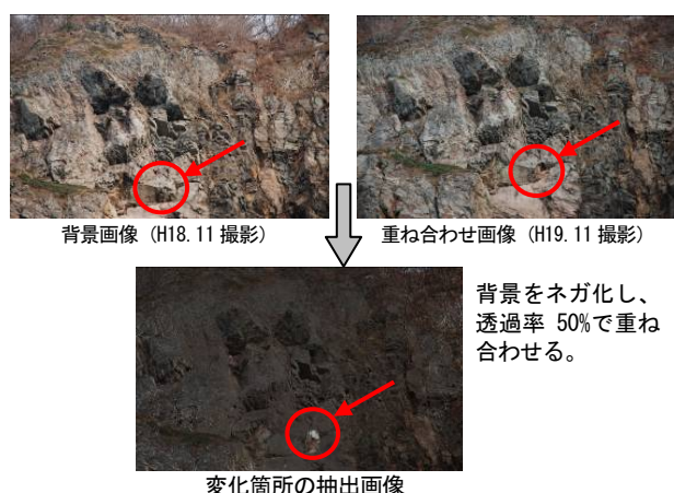
図 13 背景差分法による変化箇所抽出の概念図
