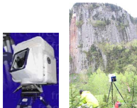
写真2 3次元レーザ・スキャナーと測量状況
