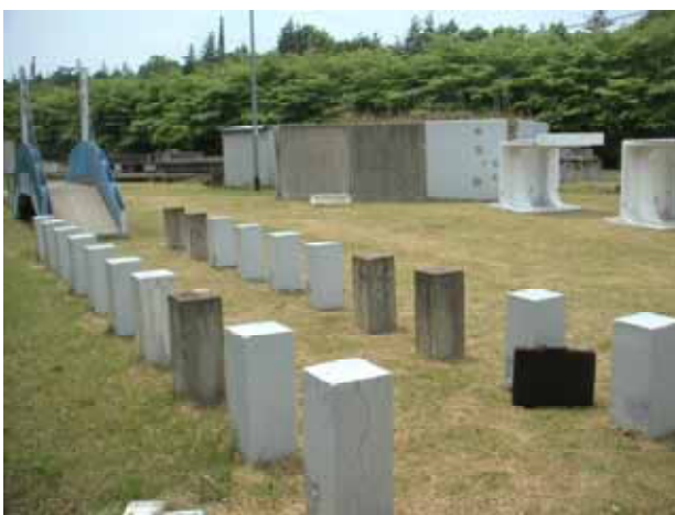
写真-2 A S R供試体の暴露状況
