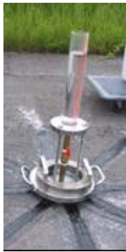
写真-2 透水量 試験状況
