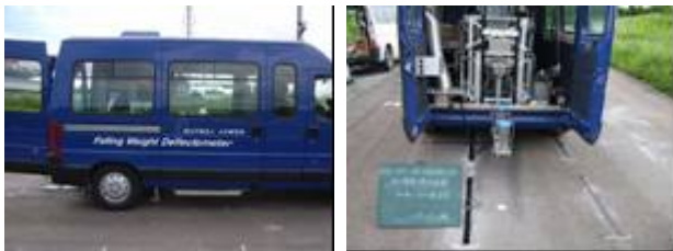
写真-4 たわみ量測定状況 (FWD)
