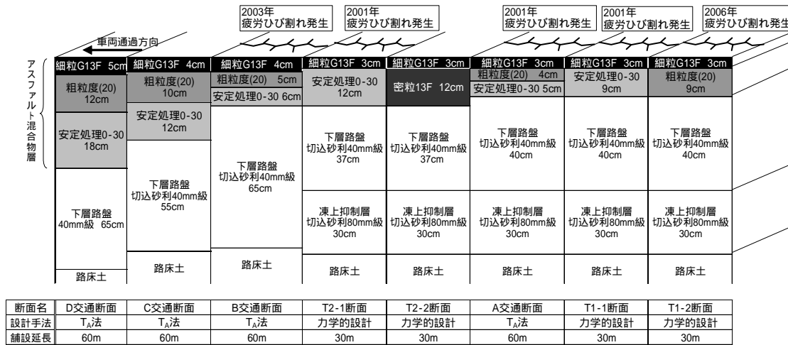
図 11 美々試験道路の疲労ひび割れ発生状況
