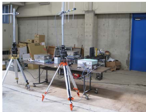
図-6 ATS受信局の消費電力量計測状況
