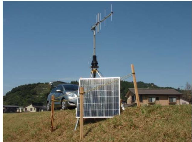
図-3 ATS の受信局設置状況 (改良後)
