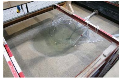
図-3.9 ケース6の排砂後の状況
