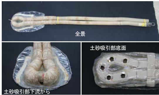
図-3.12 潜行式吸引排砂管の概要
