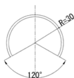
図-3.5 底面を切り欠いた管の断面形状
