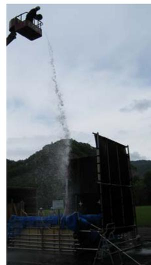
図-20 現地試験における落水水脈の状態
