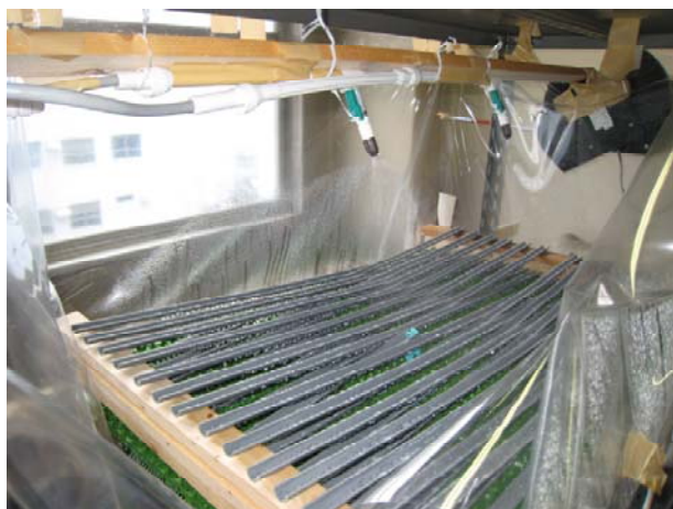
写真-3 散水量調節のための塩ビ管
