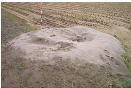
写真-1 直径 3m 程度の噴砂跡
