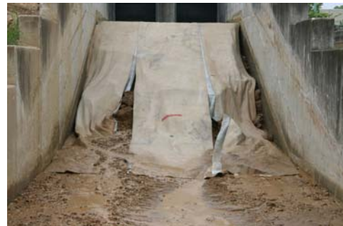
写真. 1 遮水シートによる越水対策実験
