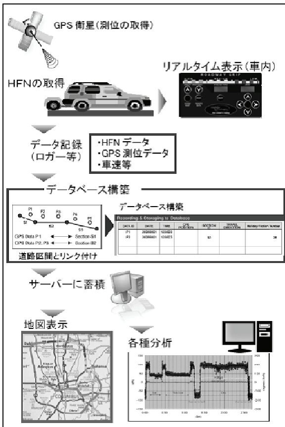
図12 路面すべり抵抗モニタリングシステム概念図
