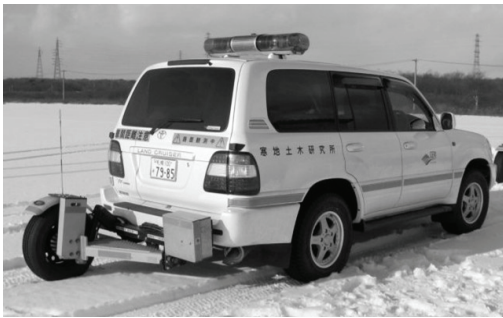
図7 連続路面すべり抵抗値測定装置（CFT）
