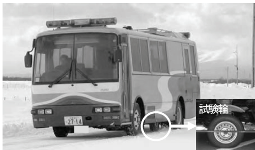
図8 路面すべり測定車
