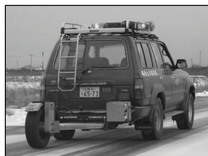
図10 連続路面すべり抵抗値測定装置
