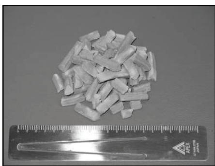
図7 固形化・成形したライムケーキ
