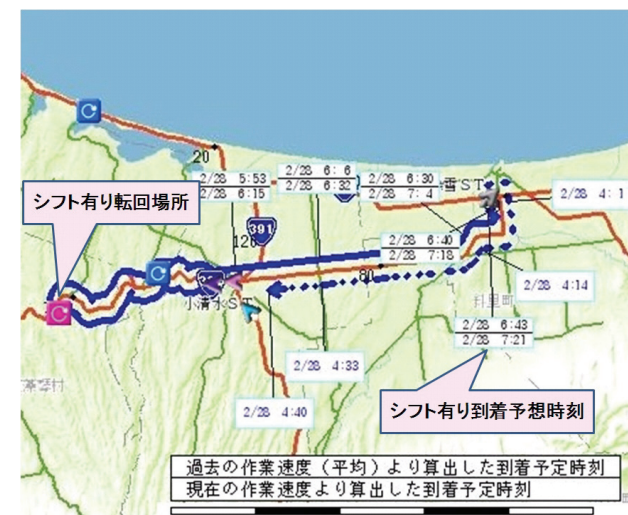
図-8 シフト有りシミュレーション(小清水工区)
