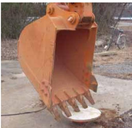
写真-2 垂直荷重実験状況
