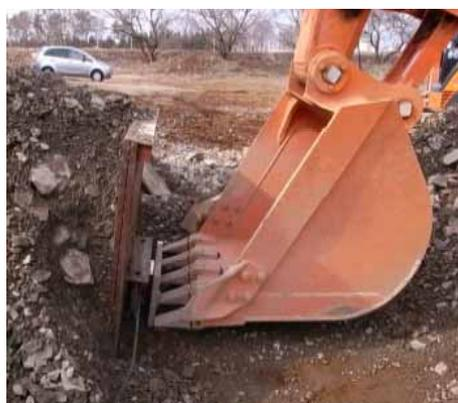
写真-3 水平荷重実験状況
