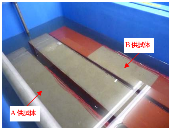
写真-5.1 凍結融解試験状況 (融解工程)
