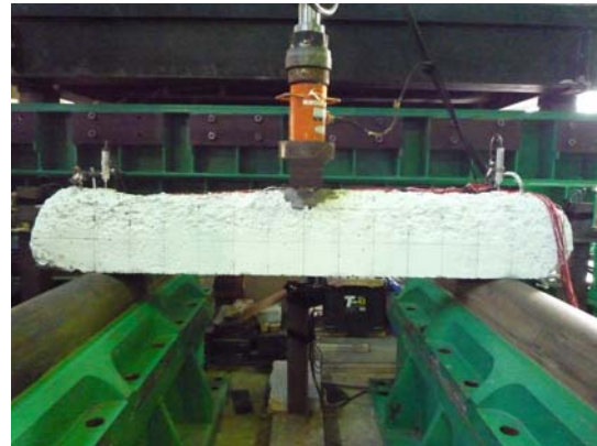
写真-5.2 凍結融解試験後のB供試体 (荷重実験前)
