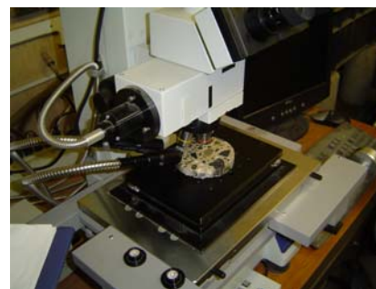
図-3.25 顕微鏡観察によるひび割れ密度測定
