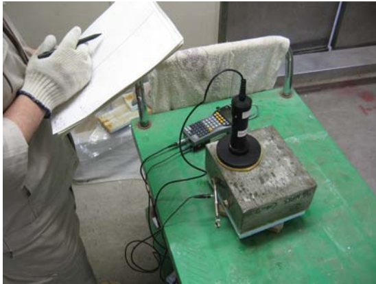
写真-3.1 腐食速度の測定状況
