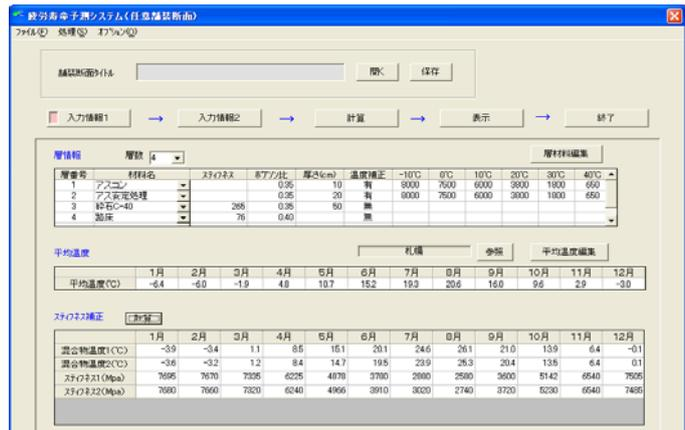
図13 任意舗装断面の疲労寿命予測システムの起動画面
