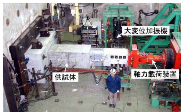
図-2 実験設置状況
