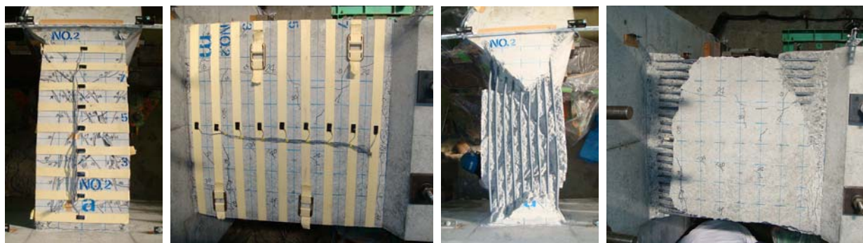
(a) 荷終了後 (b) 損傷コンクリート除去後 (2) No.2 模型 (初期緊張力なし)
