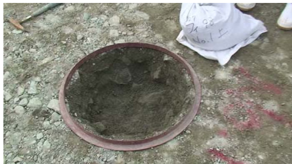
写真-2 フィルタの原位置密度試験の状況
