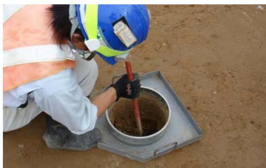
写真-1 コアの原位置密度試験の状況
