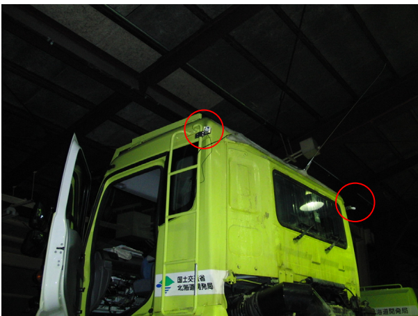
図22 ドライブレコーダーカメラ取付状況(側方)
