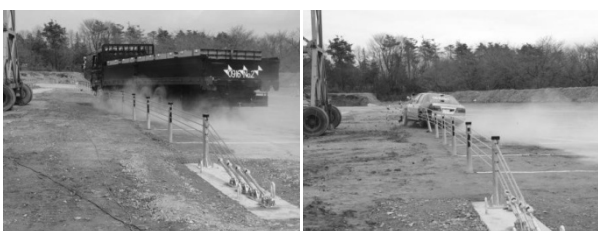
図17 分離帯用 Am 種の衝突試験の状況
