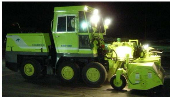
図6 ブラシ式除雪試験装置
