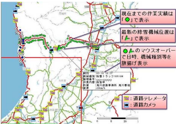
図-6 除雪作業状況確認システム
