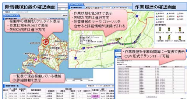
図-2 除雪機械位置の確認・作業履歴の確認
