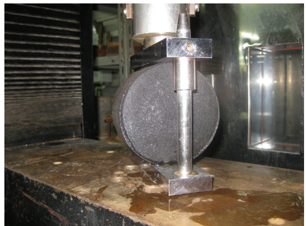
写真-1 硅砂を用いた供試体の水浸圧裂試験の様子
