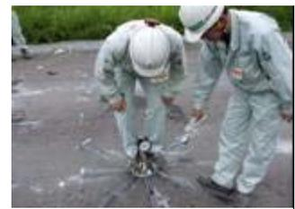
写真-4 透気量試験の状況
