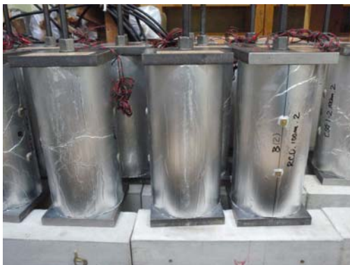
写真-3.3 封緘試験体載荷状況
