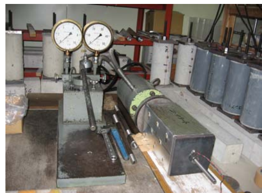
写真-3.4 角柱供試体のクリープ載荷状況
