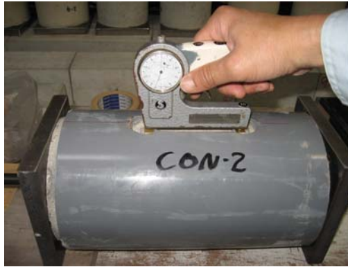
写真-3.2 塩ビで拘束した試験体
