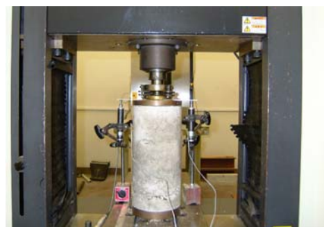
写真-2.1 繰返し載荷試験実施状況
