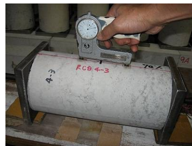
写真-3.1 PC 鋼棒式クリープ試験装置
