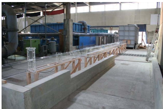
図-3.1 侵食実験水路の概要（下流から撮影）
