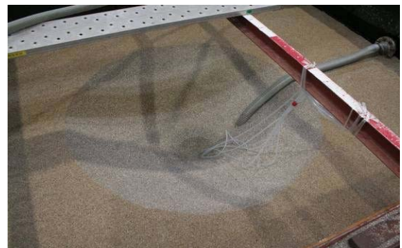
図-5.8 吸い込み口の埋没状況の例
