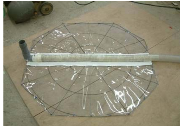
図-5.6 吸い込み口埋没対策案の例2
