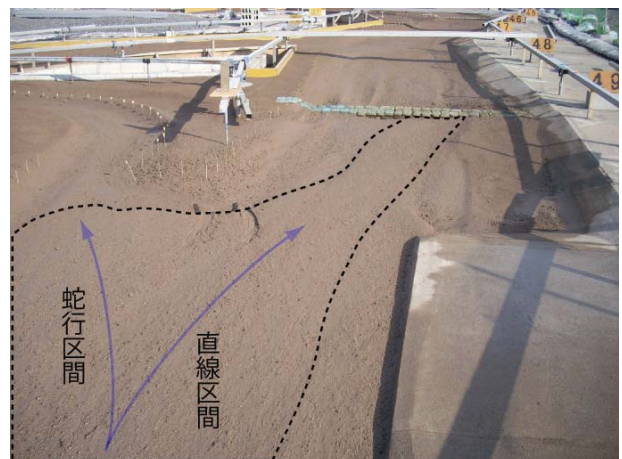
図 - 15.1.69 CASE2-2 通水後の旧川 J 分岐点における土砂堆積
