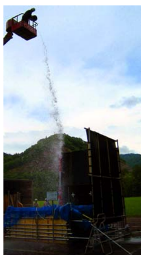
写真-18 落水水脈の状態
