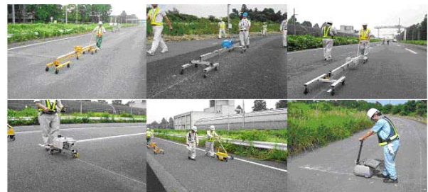
写真-6 測定装置(上段:3mプロフィールメータ、 下段:小型プロフィールメータ)
