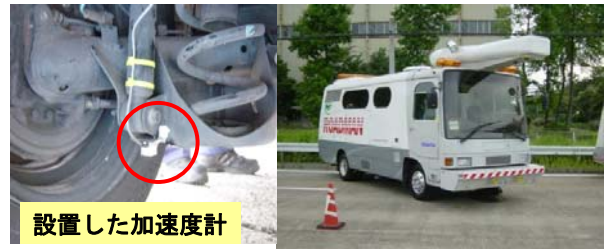
写真-11 加速度計設置状況 写真-12 路面性状測定車の一例
