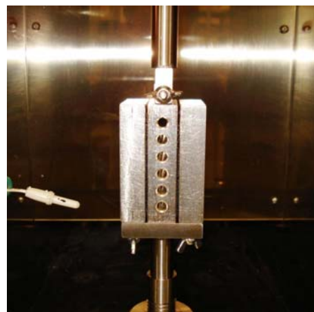
写真-1 アスファルトのせん断試験の様子
