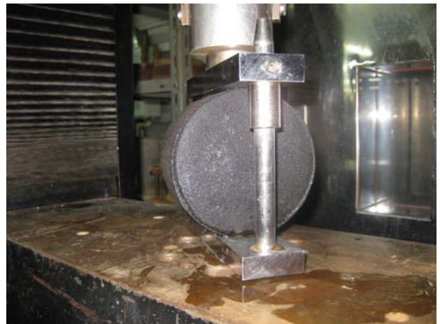
写真-10 硅砂を用いた供試体の水浸圧裂試験の様子
