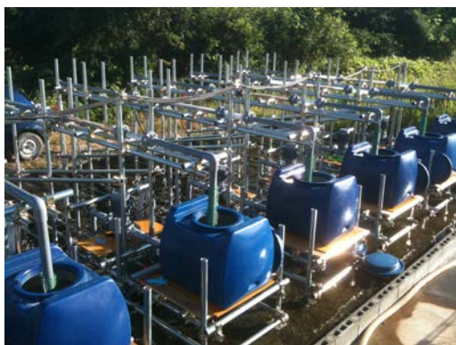
写真2 実験に用いた循環型管路
