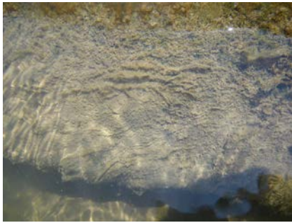
写真1 高濃度濁度水が流れる河川において、河床礫表面で観察されるシルトの堆積
