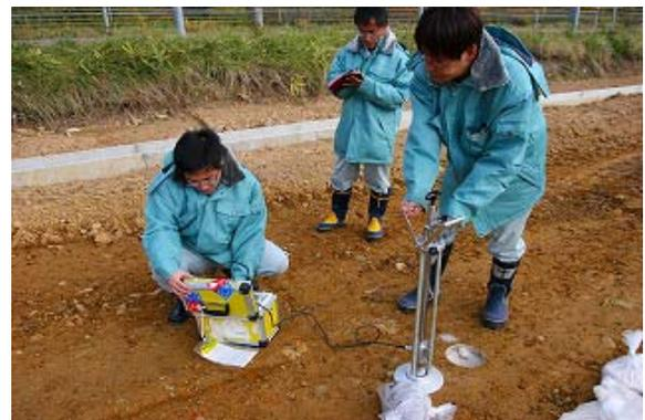
写真-2 盛土の衝撃加速度測定
