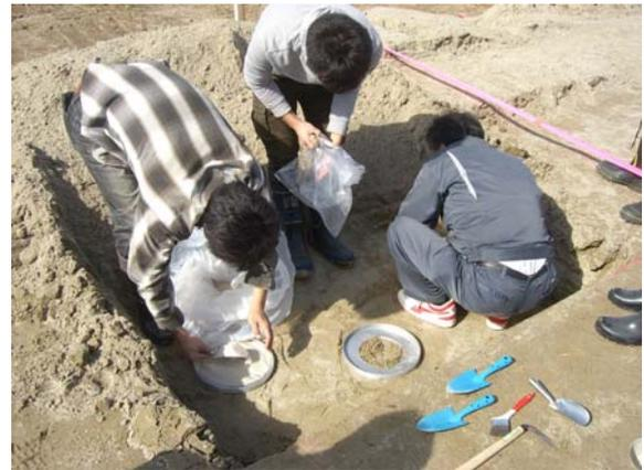
写真-1 砂置換による盛土の密度測定
