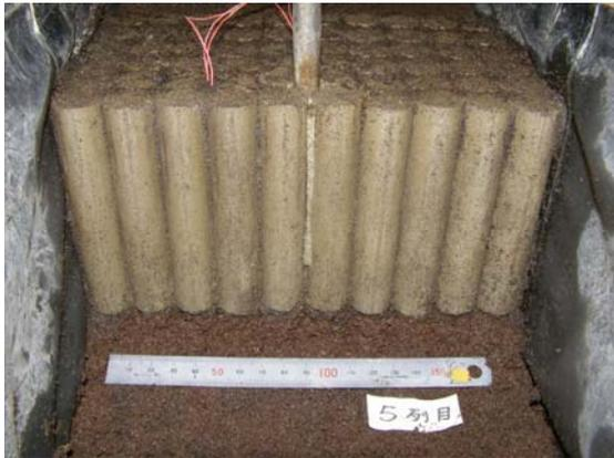
写真-1 地震動加振後の改良柱体
