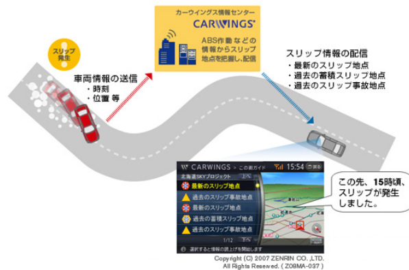
図 2 スリップ地点情報提供システム概要図
