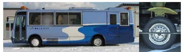
図5 路面すべり測定車(LWFT)(左:全景、右:試験輪)
