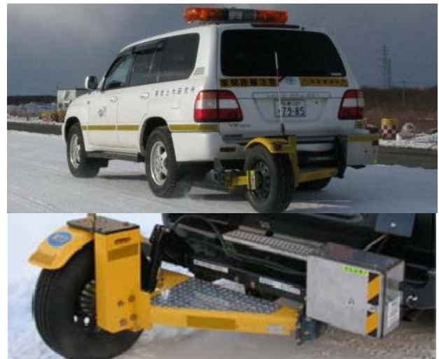
図7 連続路面すべり抵抗値測定装置 (CFT) (上：全景、下：測定輪)
