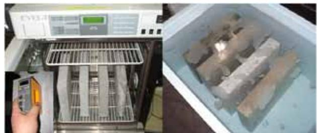
図 - 6 コンクリートの表面水分変化の測定
