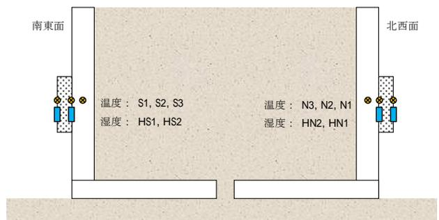
図-4 コンクリート擁壁深さ方向の温湿度観測
