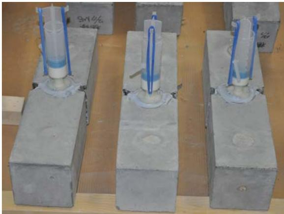
写真-3.1 自動式低圧注入工法による注入状況
