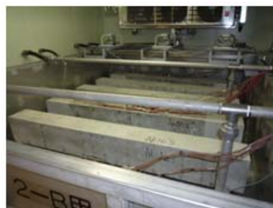
写真-3 RC梁の設置状況
