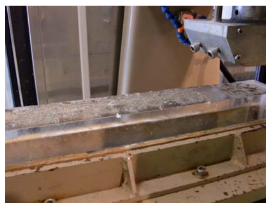
図-5 氷の表面に砂をセットした状態
