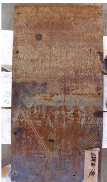
図-13 暴露試験板の撤去直後の状況
