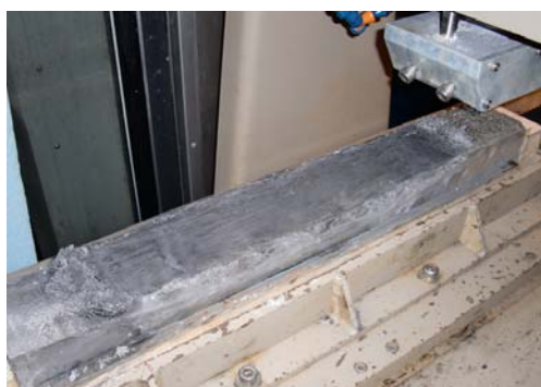
図-6 実験直後(摩擦距離 50km)の金属供試体(上)と氷(下)の表面状態の例
