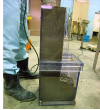
図-3 間隙通過性試験の実施状況
