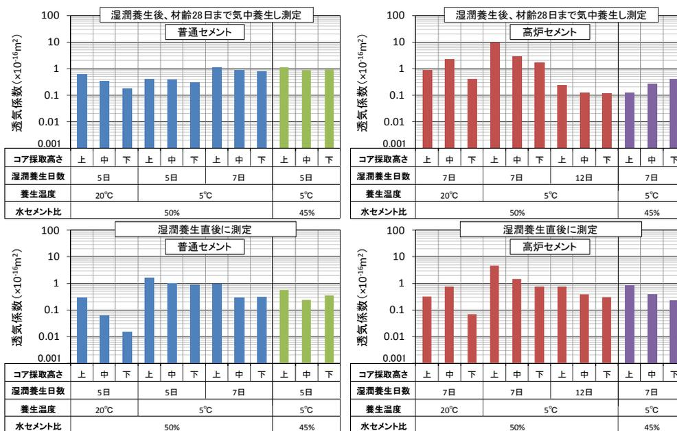
図-16 壁状供試体の透気係数
