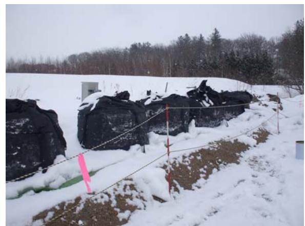
写真-4 大型土のうによる含水比低下実験
